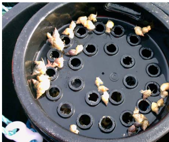
Bilde 3 - 5: Walisisk teinmodell i UV-resistent plast. Bilde 5 viser bunnen av en teine med dreneringshull som er dimensjonert etter seleksjonsønske.
